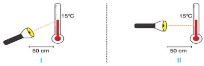
Deneyde şekilde gösterildiği gibi el fenerini önce eğik (I) sonra dik (II) gelecek şekilde aynı dereceyi gösteren termometrelere karşı 20 dakika boyunca tutuyor. 20 dakika sonunda termometrelerde okunan değerleri not alıyor.
