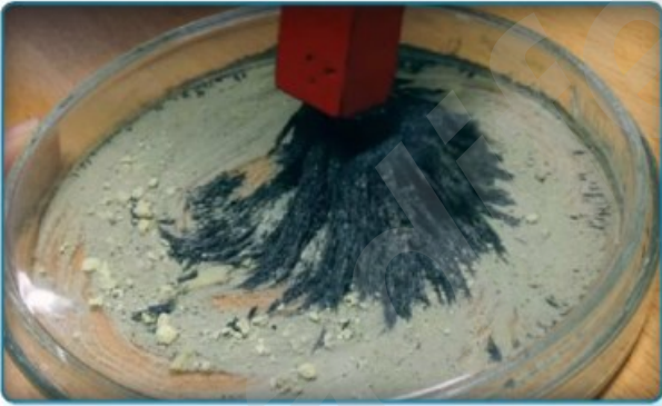
Demir tozları kükürt tozundan mıknatısla ayrılır.
