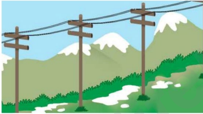
Kışın elektrik telleri (Büzülmenin etkisi)
